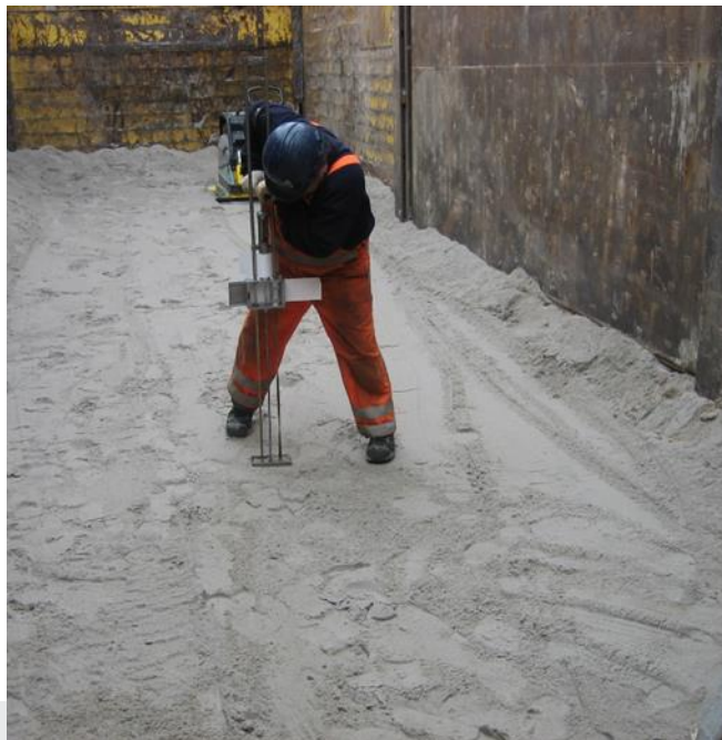
Foto: Voorbeeld van een controlemeting van de indringingsweerstand.
